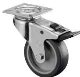
Totální brzda Zabrzdí kolo i hlavu vidlice
