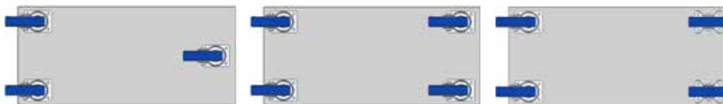
Tři otočné kladky o stejné vestavné výšce
