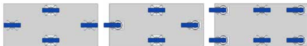
Čtyři pevné kladky, z nichž dvě střední mají o něco větší vestavnou výšku
