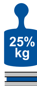
Montaż poziomy = 25 % podanej nośności
