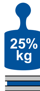
Vodorovná montáž = 25 % uvedené nosnosti
